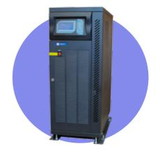
Бестрансформаторные on-line ИБП Monolith XS мощностью 10, 20, 30 кВА с двойным преобразованием напряжения, имеющие 3-фазный вход и 3-фазный выход, применяются для защиты серверных комнат, небольших офисов, телекоммуникационного и промышленного оборудования и другой нагрузки, в том числе, 3-фазной, требующей максимальной надежности электропитания. Входной коэффициент мощности, близкий к единице, позволяет эксплуатировать ИБП Monolith XS с генераторными установками.
