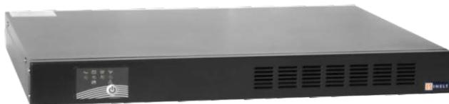
Линейно-интерактивные ИБП INELT Intelligent II RM1U мощностью 500 и 800ВА в корпусе Rack Mount высотой 1U (1 юнит) предназначены для защиты компьютерного и телекоммуникационного оборудования, установленного в 19" стойку. Синусоидальное выходное напряжение в режиме работы от батарей позволяет подключать различные типы оборудования, в том числе, с трансформаторными блоками питания.
