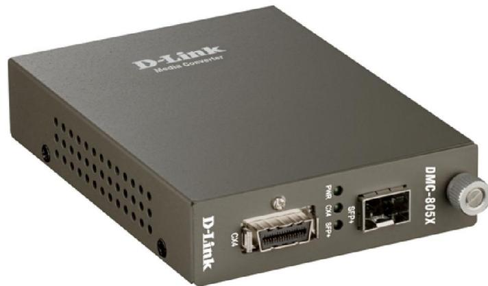
Медиаконвертер DMC-805X преобразует сигнал из стандарта 10G CX4 на сигнал 10G SFP+. DMC-805X оснащен слотом SFP+ для оптических трансиверов, выбираемых пользователем, и расширяет сетевое соединение для различных расстояний в зависимости от возможностей SFP+ трансивера. DMC-805X представляет собой высокопроизводительный медиаконвертер 10G, который позволяет увеличить расстояние для серверов, оснащенных сетевыми картами CX4 или старыми 10G коммутаторами с портами 10G CX4.
