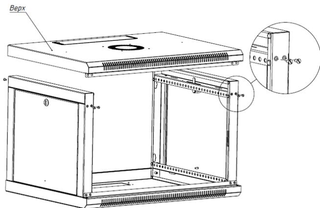
3. Прикрутите заднюю панель (G) с помощью винтов.
