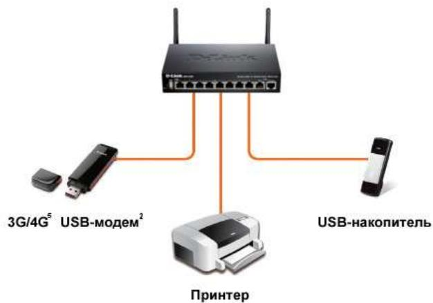
Унифицированные маршрутизаторы DSR-150/250/250N оборудованы одним портом USB 2.0
