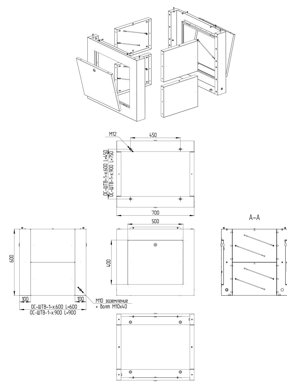
Крепление цоколя ОС-ШТВ-1-600.х непоспедственно к шкафу: 10 винтов М6х12 + 8 гаек М6
