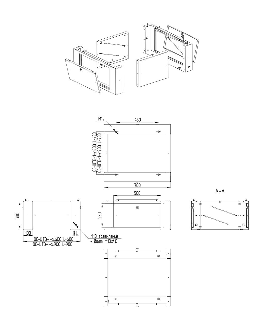
Крепление цоколя ОС-ШТВ-1-300.х непоспедственно к шкафу: 10 винтов М6х12 + 8 гаек М6
