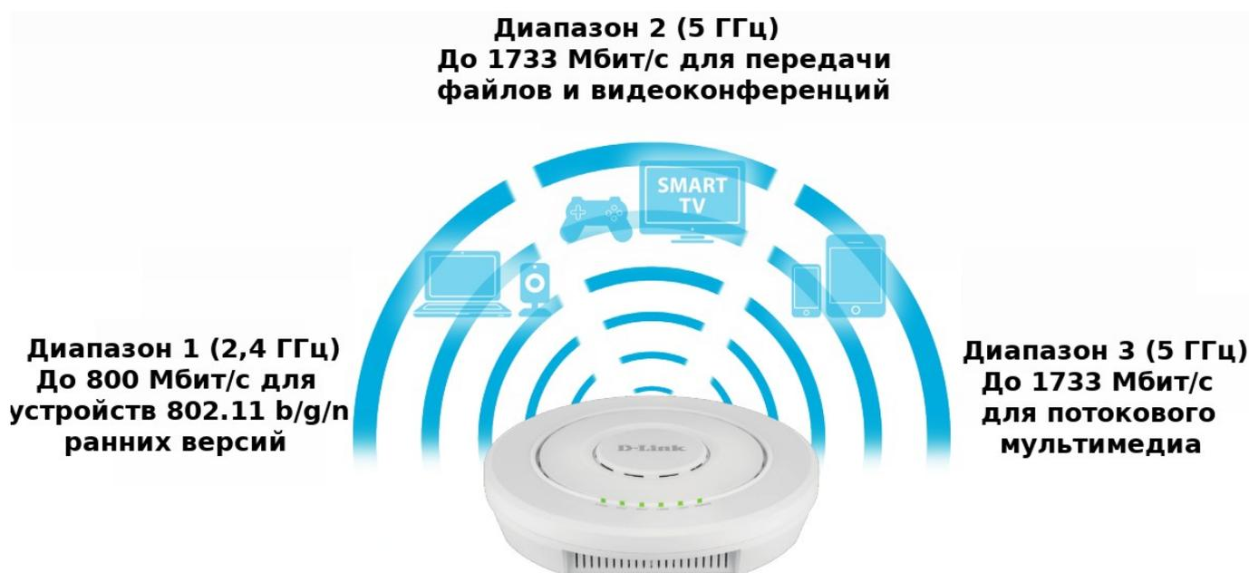
**Беспроводная двухдиапазонная унифицированная точка доступа AC2200 Wave 2 с тремя радиомодулями, поддержкой MU-MIMO и PoE**
