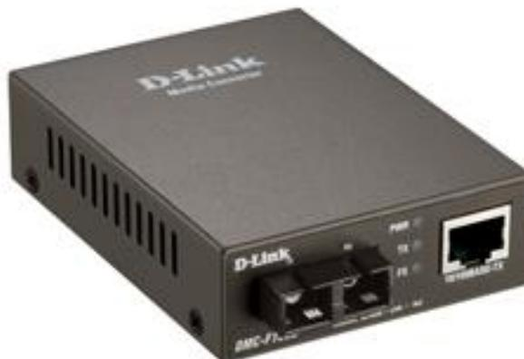
Данный медиаконвертер преобразует сигнал из стандарта 10BASE-T/100 BASE TX Fast Ethernet на витой паре в сигнал стандарта 100BASE-FX Fast Ethernet по одномодовому оптическому кабелю. Устройство оснащено 1 портом RJ-45 для витой пары и 1 оптическим портом с разъемом SC.
