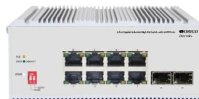
Коммутатор поддерживает стандарты PoE (802.3af), PoE+ (802.3at) и PoE++ (802.3bt) с возможностью подачи питания до 90 Вт на порт при общем PoE-бюджете 185 Вт. Для систем видеонаблюдения реализованы режимы VLAN и CCTV, позволяющие изолировать трафик PoE-портов и увеличить дальность передачи данных и питания до 250 м.
