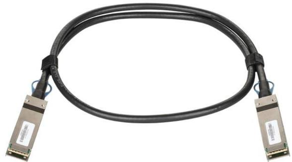
Твинаксиальный пассивный 100G QSFP28 кабель предназначен для соединения 1 между собой коммутаторов с 100G портами. Кабель OM-K100-100 оснащен разъемами QSFP28 и используется для подключения на расстоянии до 1 м.
